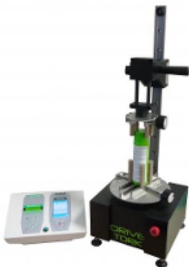
Per eseguire una misurazione accurata e ripetitiva della coppia, è spesso necessario utilizzare un banco di torsione a **velocità costante programmabile**. Il torsionometro verticale motorizzato Drivetork permette di effettuare le misurazioni senza l'influenza dell'operatore grazie ad una rotazione regolata a velocità costante.
