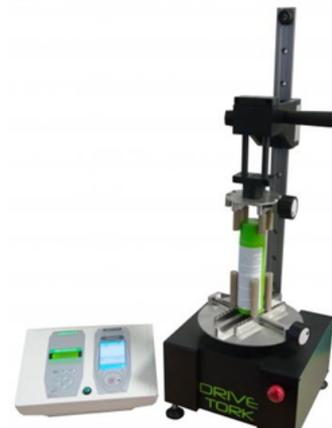
Banchi di torsione manuali, motorizzati e controllati dal computer
