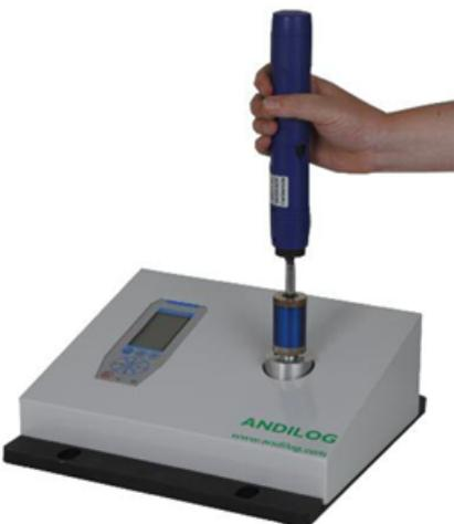
I **simulatori di avvitatura della gamma RDA** sono progettati per fornire misurazioni di coppia ripetibili e coerenti per utensili elettrici o pneumatici. Grazie al loro sistema di rotazione e molla, permettono agli utensili elettrici o pneumatici di ruotare per raggiungere la coppia massima.
