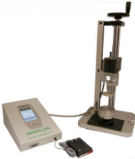
La Springtest 2 è un sistema appositamente progettato per la misurazione molto accurata delle molle a compressione. Questo banco prova ad azionamento manuale è progettato per misurare piccole molle e basse forze.
