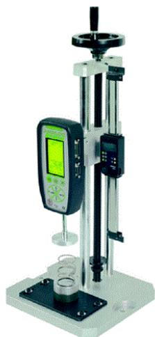
Il semplice banco prova manuale BAT1000R è attrezzato per prove complete: un sensore digitale è montato lungo le colonne per misurare lo spostamento del banco.
